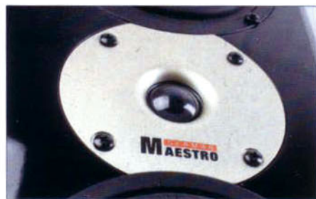
Die sehr enge Anordnung der Treiber lässt eine genauestens berechnete D'Appolito-Lautsprecherkonstruktion vermuten, die für ein weitreichendes Abstrahlverhalten des Lautsprechers sorgt
