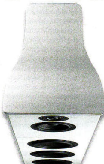
Das Gehäuse hat eine breite Schallwand und verjüngt sich nach hinten, was stehende Wellen vermeidet
